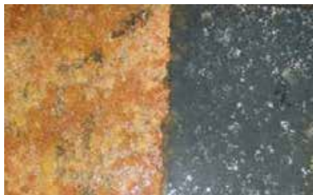
강판의 염수 분무 시험 결과. Post-Tech PTI 처리된 부분(오른쪽)과 처리되지 않은 부분(왼쪽)
