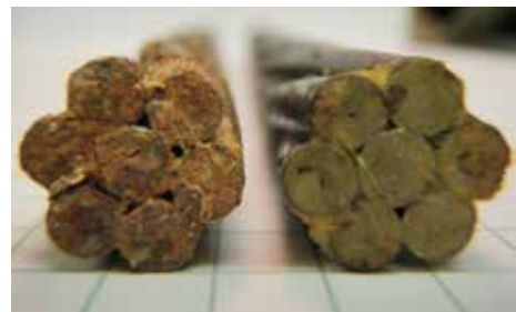
강연선의 염수 분무 시험 결과. Post-Tech PTI 처리된 강연선(오른쪽)과 처리되지 않은 강연선(왼쪽)
